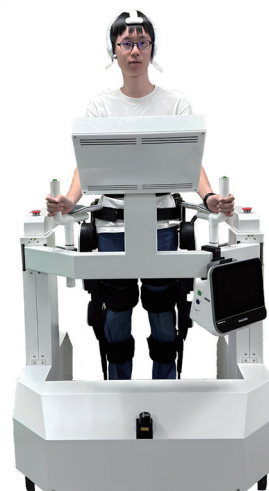
▲ 圖十一、結合新型腦機介面的全面性復健系統。 （資料來源：作者提供）
